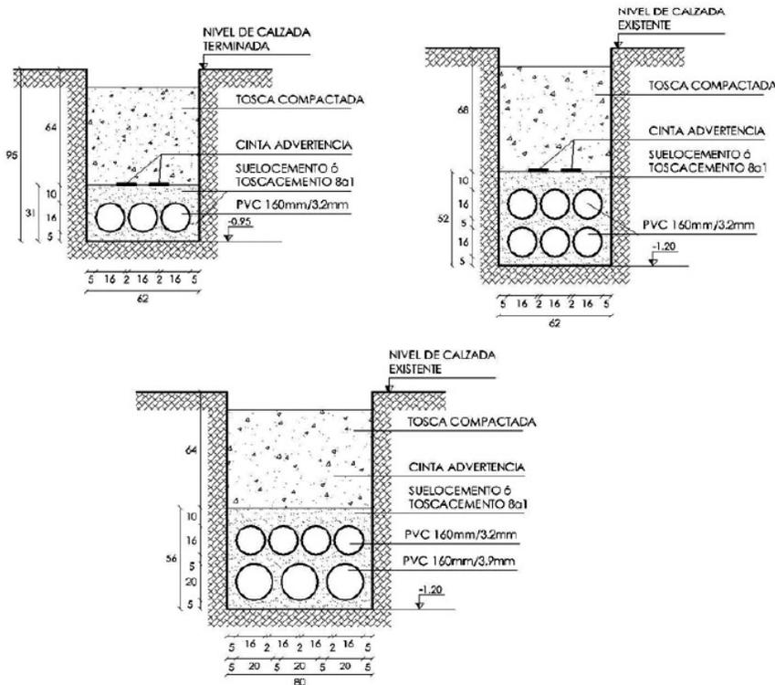
Para la realización de suelo-cemento se mezclan en hormigonera y sin agregar agua, 1 parte de Cemento Portland por cada 8 partes de suelo natural extraído de la excavación, el tiempo suficiente que permita obtener una mezcla homogénea de los componentes. Se vierte el material seco en el cruce en capas de no más de 5 cm distribuyéndolo uniformemente.
